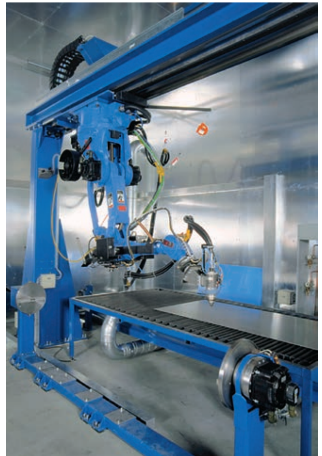
Laser-Schneidzelle: 50 kg Roboter an Portalfahrbahn
