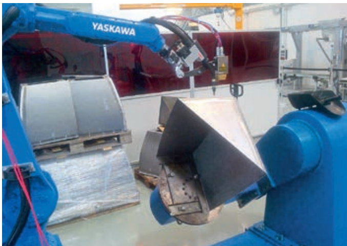
Nahtverfolgung mit MIG/MAG-Brenner
