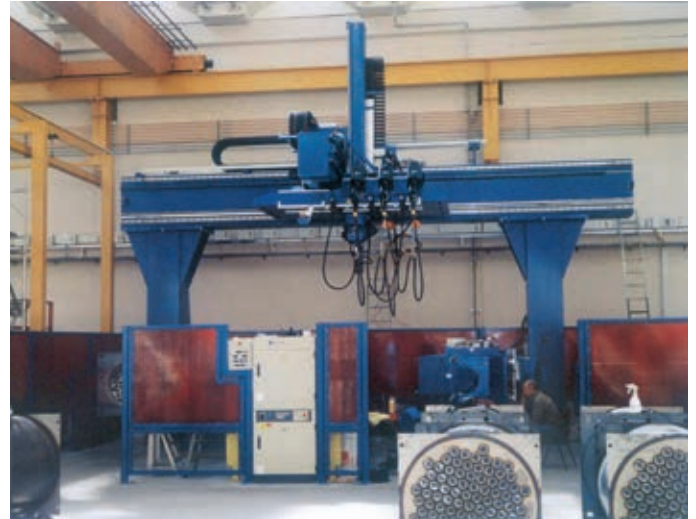
Dreiaxige Portalfahrbahn zum Verschweißen von Großheizkesseln
