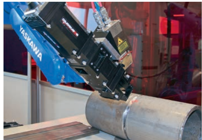
Nahtverfolgung mit Laser Schweißkopf
