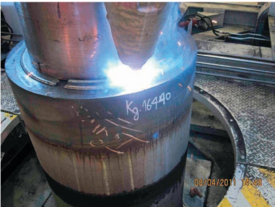
Beispiel für Mehrlagenschweißung an ESU-Elektroden: variabler Lagenaufbau für Auftrags- und Verbindungsschweißung
